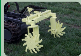
Sternrollhacke mit Front- oder Heckanbau, hydraulischer Breitenverstellung
