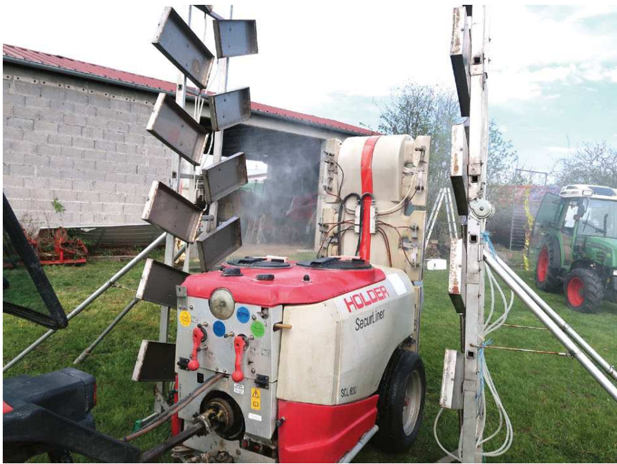
Plattenprüfstand für Raumsprühergeräte: Das Gerät fährt in der Grundeinstellung durch den Prüfstand.
