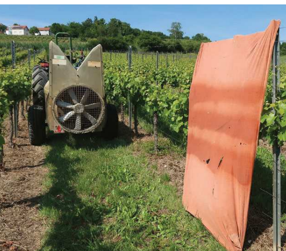
Die Applikationsqualität lässt sich auch mit einem Tuch testen: hier im linken Bild mit der Düse Lechler AD 02 90° und 8 bar und rechts mit einem Spritzwinkel von 120° und 8 bar.
