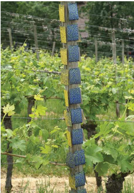
Test mit wassersensitivem Papier: Applikationstest bei Behandlung jeder zweiten Gasse
