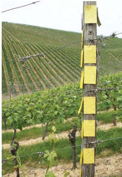
Test mit wassersensitivem Papier: Applikationstest bei Behandlung jeder zweiten Gasse
