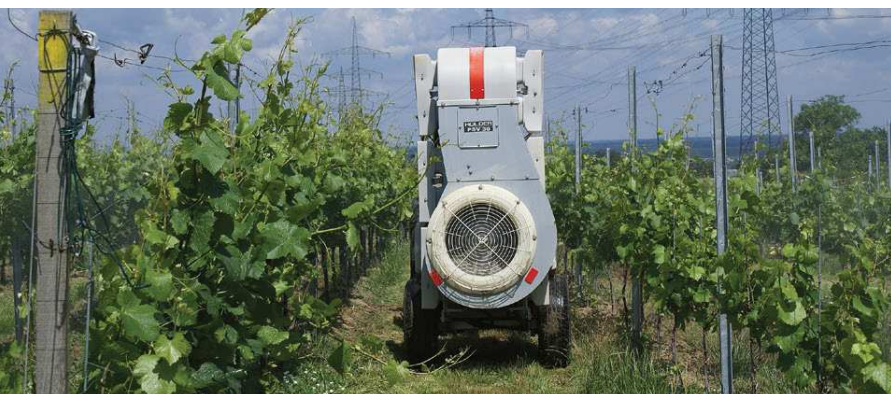
Die Applikationsqualität anhand des Spritznebels zu beurteilen, birgt viele Fehler. Da in diesem Beispiel gut appliziert wird, ist kaum etwas zu sehen.
