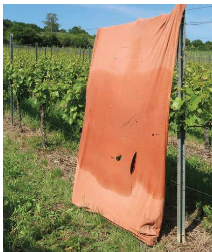
Die Applikationsqualität lässt sich auch mit einem Tuch testen: hier im linken Bild mit der Düse Lechler AD 02 90° und 8 bar und rechts mit einem Spritzwinkel von 120° und 8 bar.
