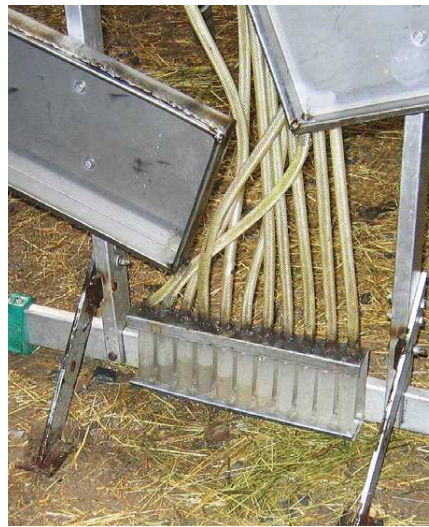
Plattenprüfstand: Die Flüssigkeitsverteilung in den verschiedenen Zielhöhen wird überprüft.
