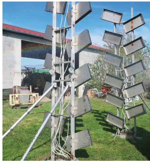
So ist ein Plattenprüfstand für Raumsprühgeräte aufgebaut.
